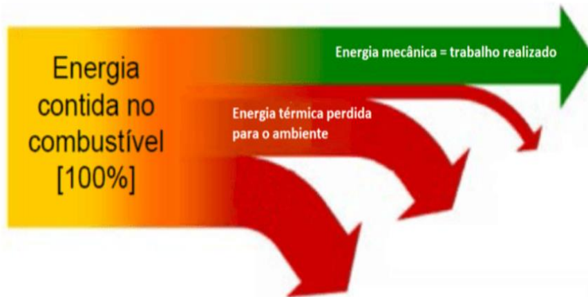
Figura 1 – Diagrama do fluxo de potência de um motor de combustão interna
