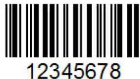
Figura 5 – Código de barras do tipo Code 2 of 5
