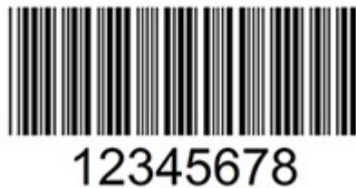
Figura 3 – Código de barras do tipo Code 39
