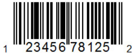
Figura 6 – Código de barras do tipo UPC
