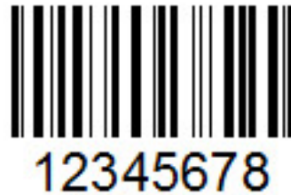
Figura 4 – Código de barras do tipo Code 128
