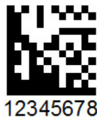
Figura 9 – Código de barras do tipo Data Matrix
