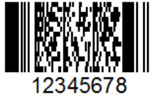
Figura 8 – Código de barras do tipo PDF417
