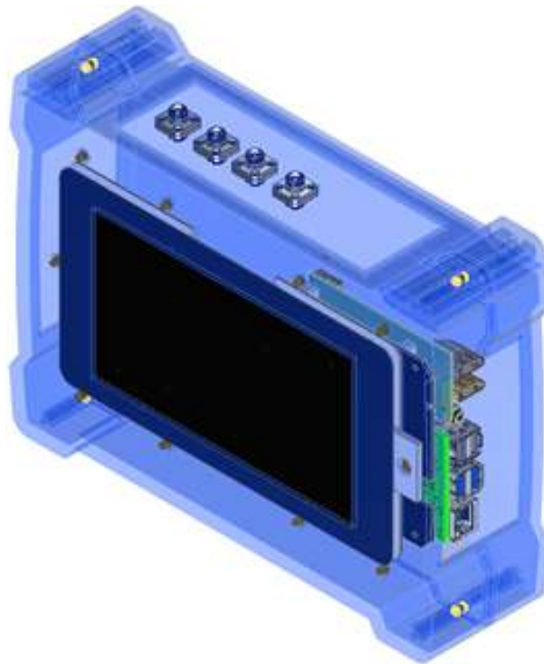
Figura 8 – CAD do encapsulamento proposto
