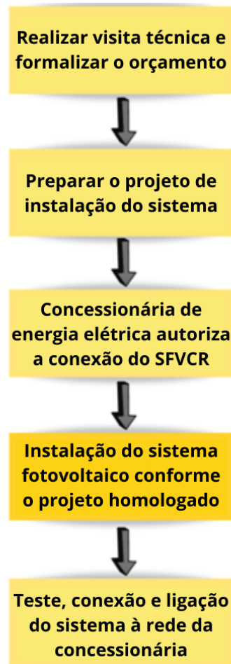
Figura 14 – Sequenciamento dos processos gerais de instalação do SFVCR
