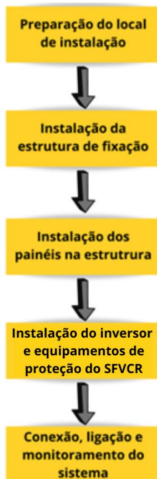
Figura 18 – Sequência de de processos específicos de instalação do SFVCR
