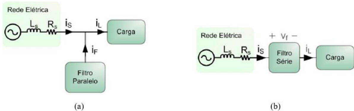
Figura 10 – Filtros ativos. (a) Filtro série paralelo e (b) filtro série ativo
