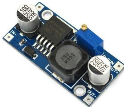
Figura 15 – Regulador de tensão lm2596
