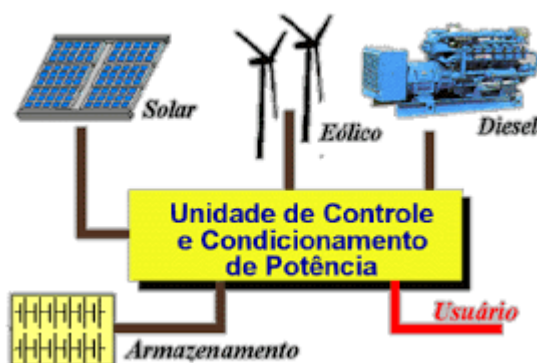
Figura 18 – Sistema fotovoltaico híbrido
