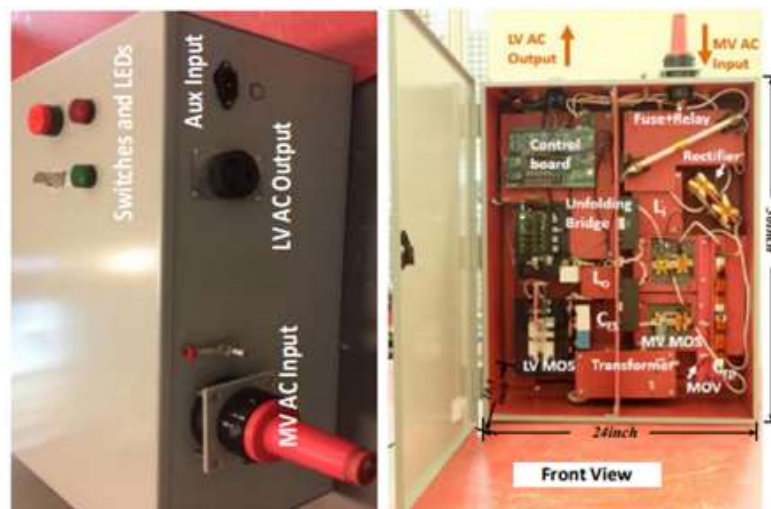
Figura 7 – Chassi do FREEDM System Gen. III: parte externa (a) e interna (b)
