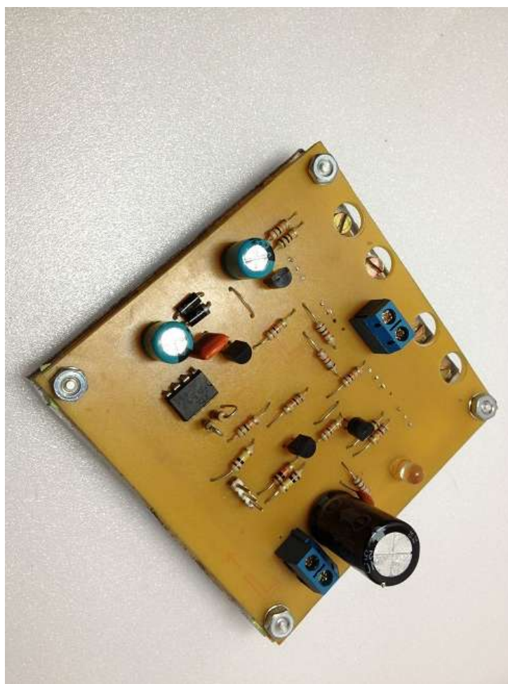
Figura 9 – Ponte H mais robusta desenvolvida para a movimentação vertical
