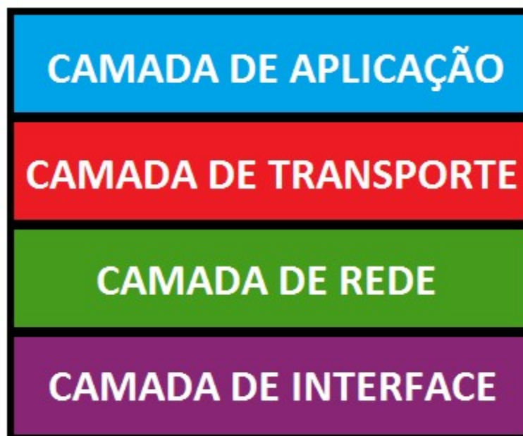
Figura 5: Representação em camadas do protocolo TCP/IP
