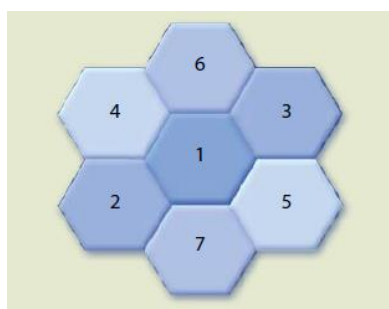
Figura 19 - Cluster de sete células
