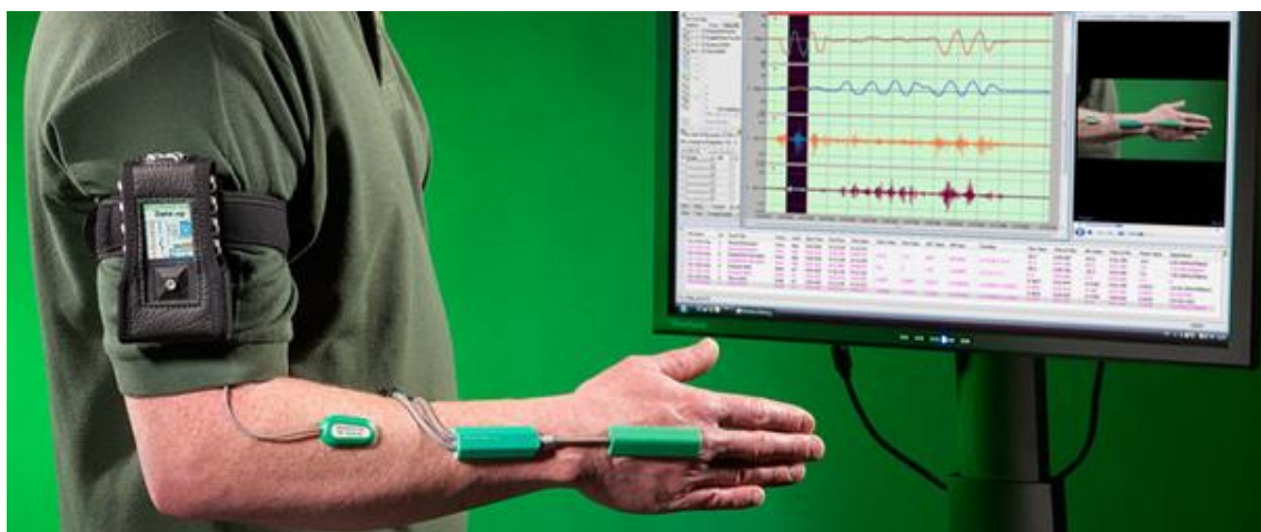
Figura 8 – Eletrogoniômetro flexível da empresa Biometrics.
