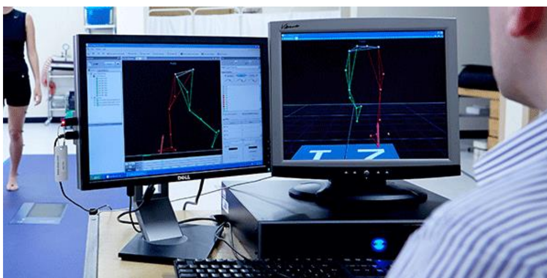
Figura 6 – Sistema Vicon realizando captura de movimento.
