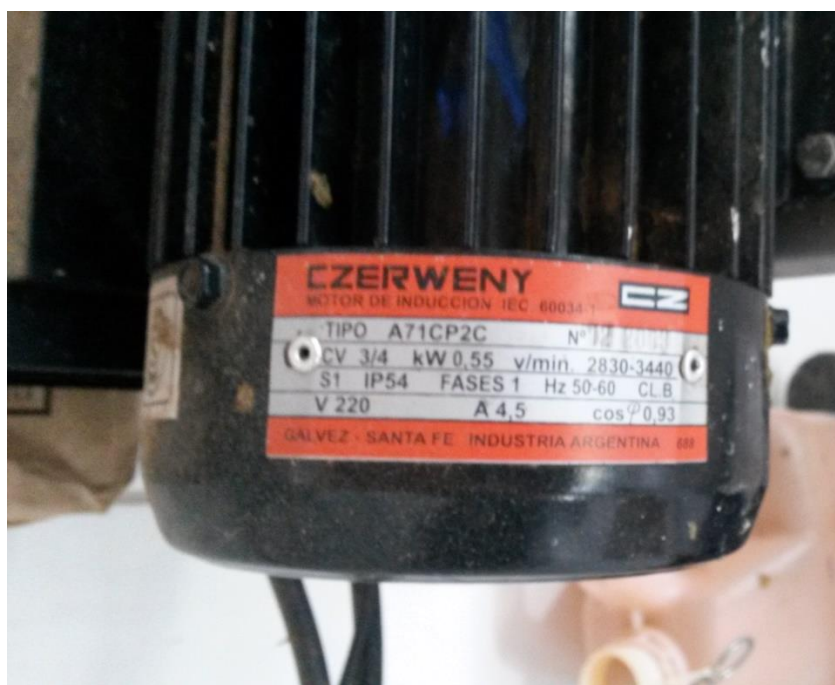
Figura 9 - Dados de placa do segundo motor da ordenha.
