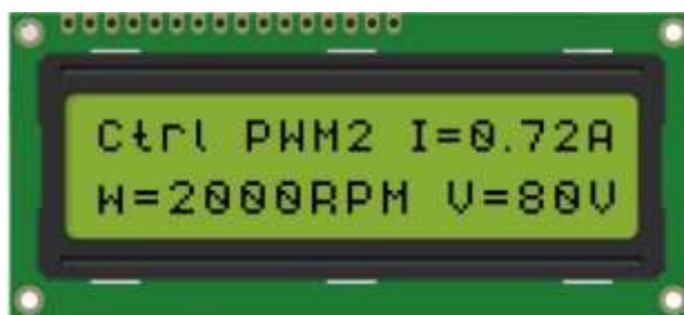
Figura 50 – Apresentação dos Dados: Controle do Motor em MA, PWM.
