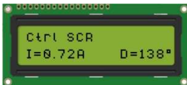
Figura 49 – Apresentação dos Dados: Controle do Motor, Controle de Fase.
