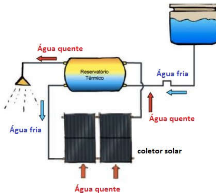
Figura 16 - Efeito sifão provocado pela diferença de densidade da água.
