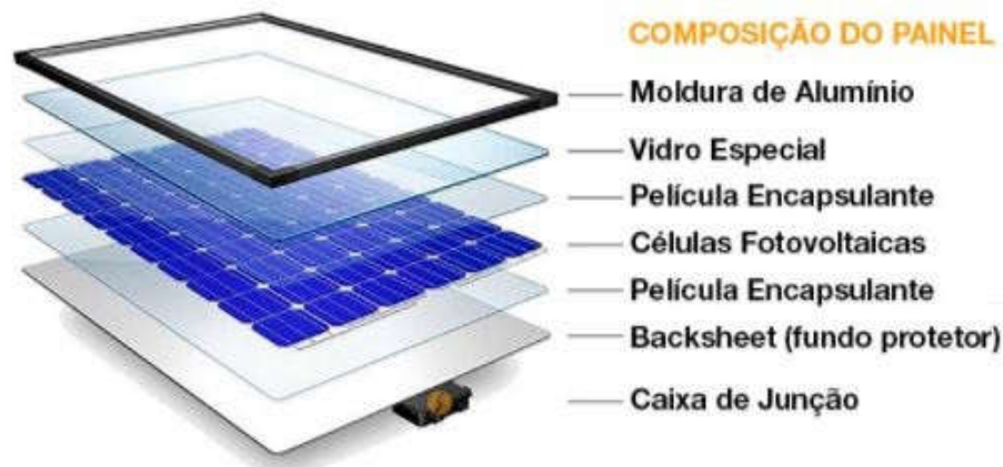
Figura 10 - Composição de um painel fotovoltaico rígido
