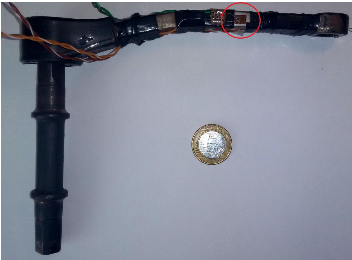
Figura 33 – Pedivela selecionado com extensômetro em destaque
