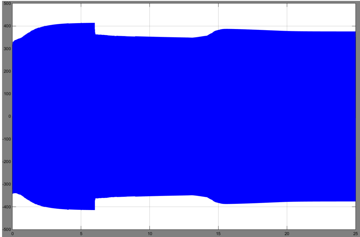
Figura 40 – Envoltória da tensão da fase A durante o processo de aceleração do sistema
