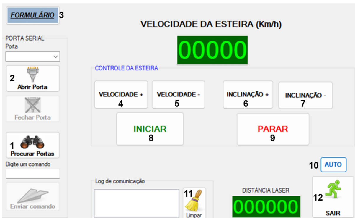
Figura 5 – Interface gráfica desenvolvida para controle de velocidade, inclinação, início e parada da esteira ergométrica.
