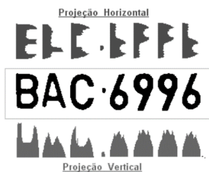
Figura 11 – Projeção Horizontal e Vertical
